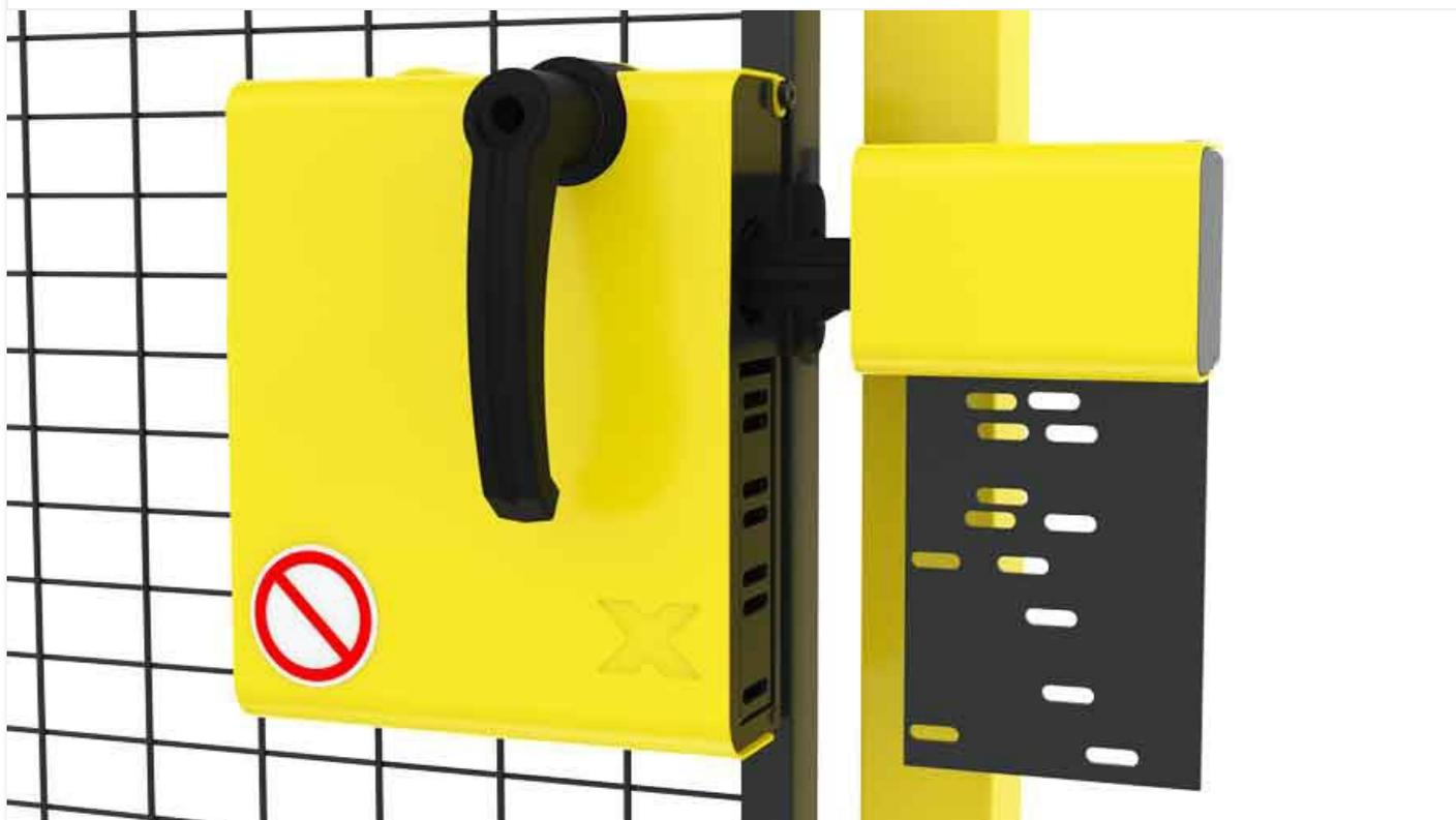
Inoltre, è possibile prevenire la chiusura accidentale della porta montando una piastra con tre fori sul lato di X-Lock, che può essere chiusa con un lucchetto quando la porta è aperta. In questo modo si ottiene la massima sicurezza possibile durante gli interventi di manutenzione. X-Lock è conforme alla norma EN ISO 12100, capitolo 5.5.3.
