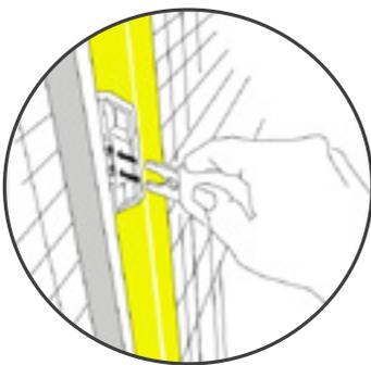
Per staccare il pannello è sufficiente inserire la X-Key nel raccordo superiore e
